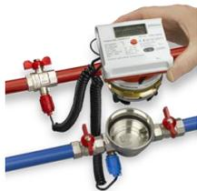
Un contatore a ultrasuoni ha grandi vantaggi tecnici (precisione e range di misurazione migliori, sicurezza in caso di sovraccarico, più flessibilità nella scelta della posizione di installazione, normalmente non necessita di tratti rettilinei in prossimità del contatore e una migliore applicazione nei casi di fluido con presenza di impurità), e comporta nel tempo anche vantaggi economici per il cliente, secondo quanto previsto dalla legge italiana.
